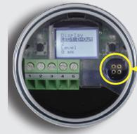
Plugue de conexão para o adaptador MPI-200-F como um plugue intermediário entre o sistema eletrônico ITM-51 e a conexão MPI-200 3 (veja a próxima figura).
